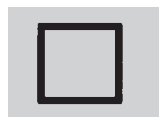
Profilé de tube 30x30x2 mm pour plaque de 32 mm L = 6 m satin anodisé
