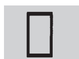
Profilé de tube 30x15x2 mm pour plaque de 16 mm L = 6 m satin anodisé
